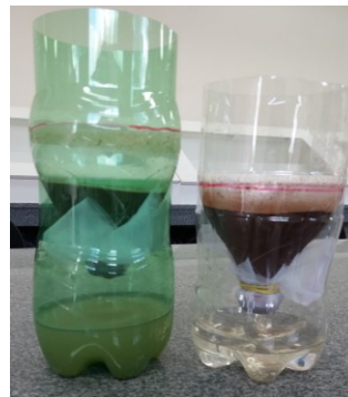
Figura 3 – Funis de garrafa pet usados para atividade de permeabilidade de solos.
