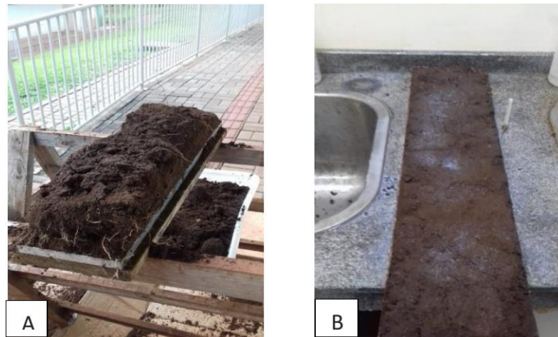
Figura 2 – (A). Rebaixamento do Perfil; (B). Impregnação.
