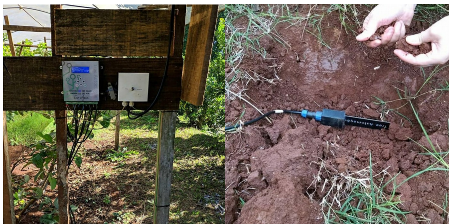
Figura 2 – Sistema instalado em uma estufa de goiaba (esquerda) e sensor UMI enterrado no solo (direita)
