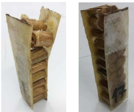
Figura 5 – (a) Falha da amostra produzida com resina PU. (b) Falha da amostra produzida com resina epóxi.
