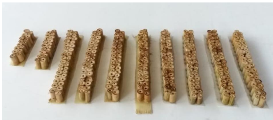
Figura 4 – Laminação das amostras utilizadas para o ensaio Izod.
