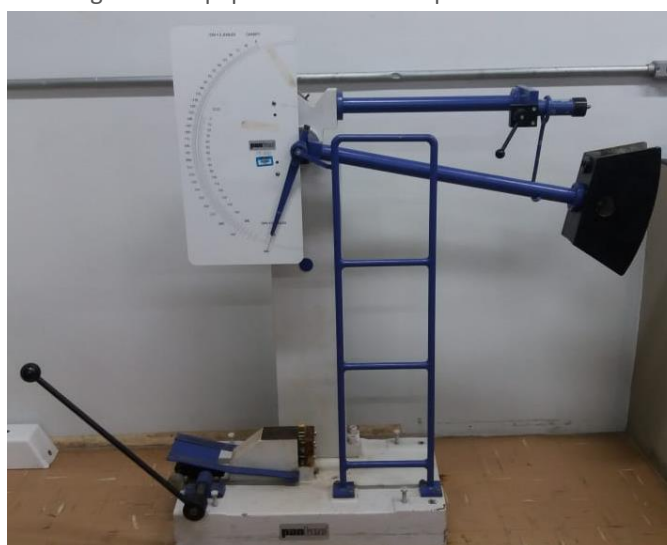
Figura 3 – Equipamento utilizado para o ensaio Izod.
