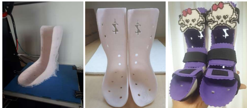
Figura 5 – (a) órtese sendo impressa em uma impressora 3D; (b) par de órteses impressas; (c) modelo finalizado das órteses
