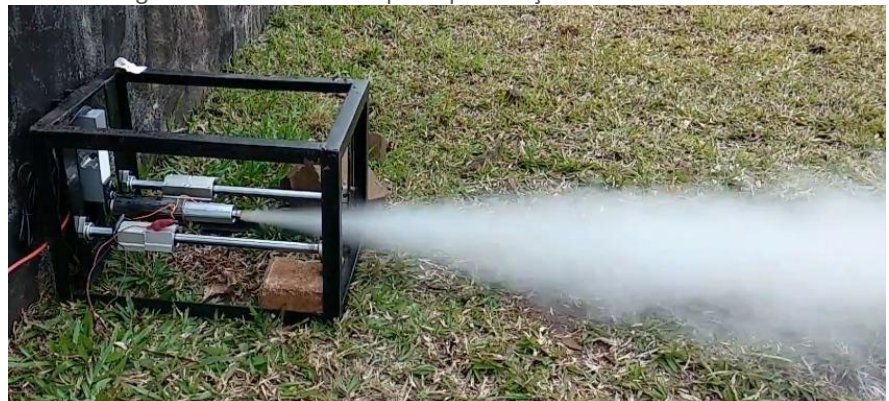
Figura 4 – Teste estático para qualificação do motor classe F.
