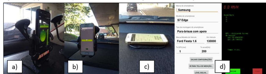
Figura 2 - Suportes veiculares utilizados: a) para-brisas com apoio, b) para-brisas sem apoio e c) painel; e d) interface da versão preliminar do aplicativo desenvolvido.
