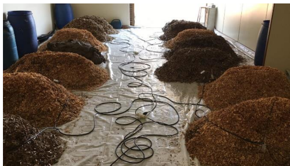
Figura 5 – Experimento realizado para verificação da compostabilidade de lodo da ribeira.
