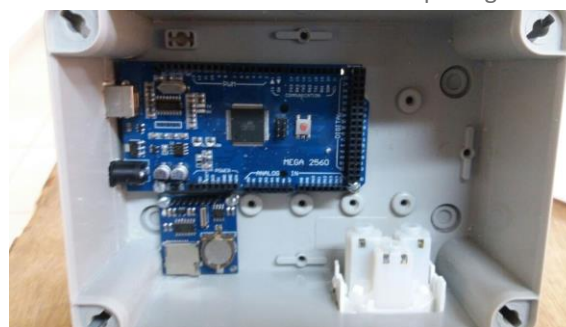
Figura 3 – Hardware montado em uma caixa de passagem em PVC.
