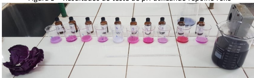
Figura 5 – Resultados do teste de pH utilizando repolho roxo
