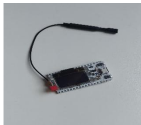
Figura 2 – Heltec LoRa esp32, junto com sua antena
