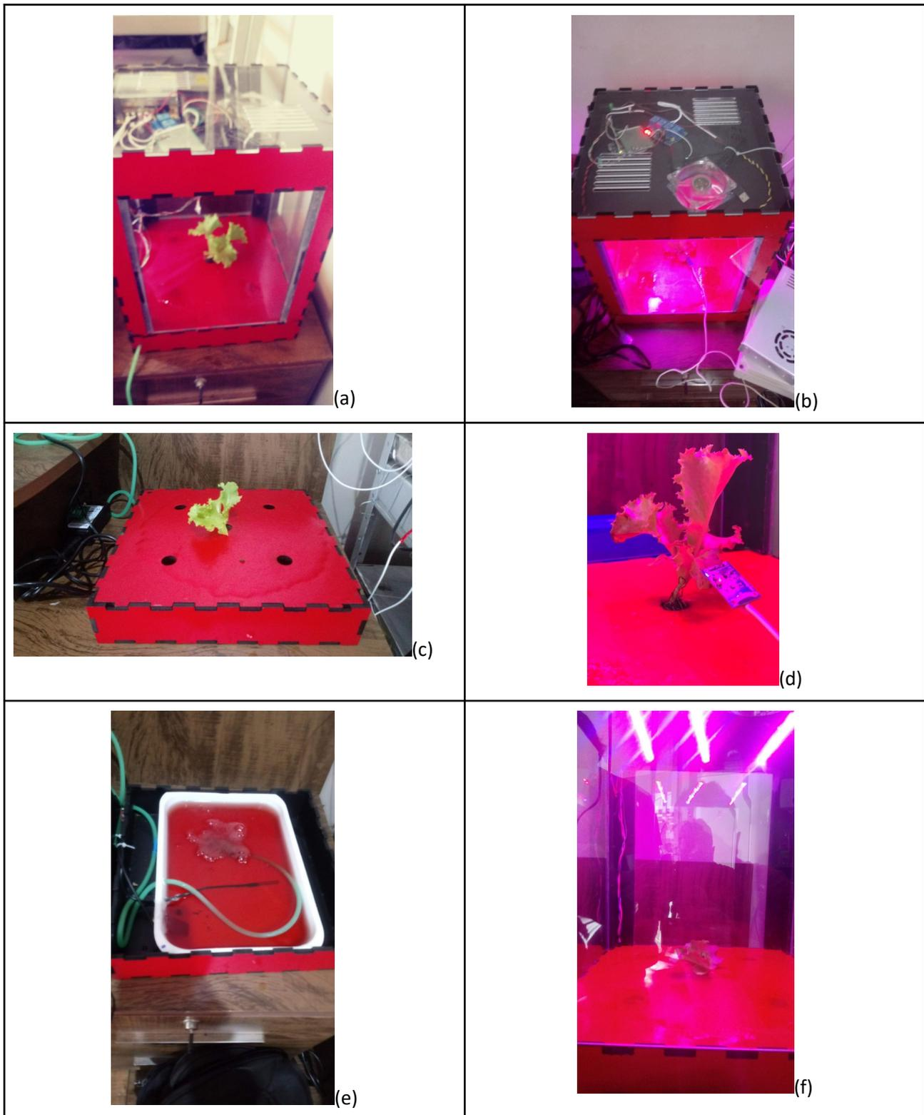
Figura 2:- Detalhes da mini-estufa (a) visão geral; (b) Parte superior com placa; (c) suporte das plantas (d) alface e sensor; (e) reservatório com solução e aeração; (f) área de crescimento com planta e iluminação LED vermelho e azul.
