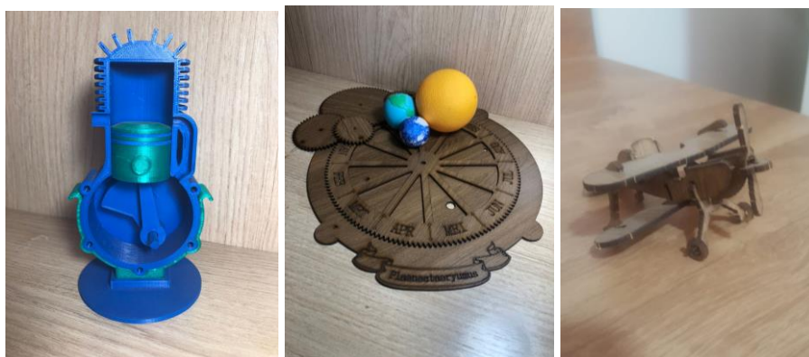
Figura 1 - Protótipo impresso em 3D de um conjunto cilindro pistão de um motor a combustão interna
