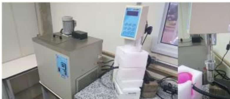
Para as medidas, como o fluido de calibração utilizado possui viscosidade definida em certas temperaturas, a coleta de dados foi feita à 20°C onde o fluido apresenta viscosidade definida de 136,1 cP.
