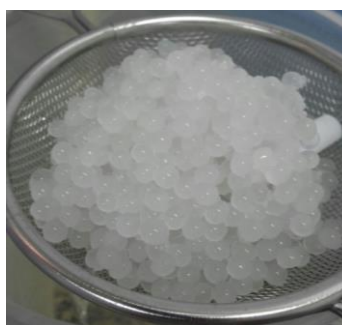
Figura 1 – Cápsulas de alginato de cálcio contendo células da levedura Saccharomyces cerevisiae
