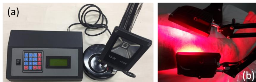
Figura 3 – (a) Fonte de iluminação com lâmpada de diodo emissor de luz, desenvolvida nesse trabalho e (b) aplicação do sistema no tratamento de feridas. Fonte: Autoria própria.
