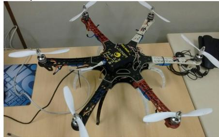
Figura 2: Frame Hexacóptero montado com placa Erle-Brain
