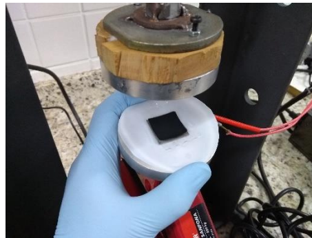
Figura 2 – MEA preparado para o hot-pressing .
