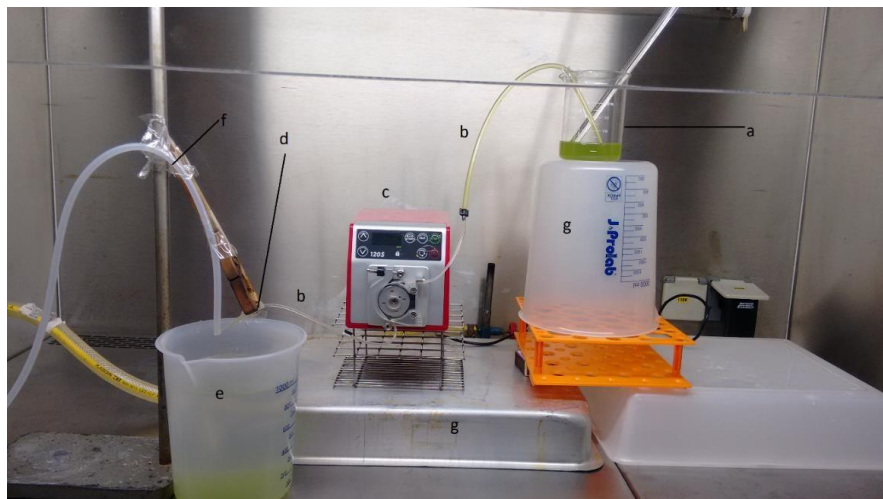
Figura 1. Sistema gerador de micropartículas. a) Solução de alginato 1,5% acrescida de Chlorella vulgaris . b) Mangueira da bomba peristáltica. c) Bomba peristáltica Watson-Marlow modelo 120S. d) Ponteira de micropipeta 200 \mu L. e) Solução de CaCl 2 125mM. f) Mangueira de 1,5m provida do biorreator. g) Suportes auxiliares.
