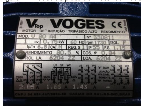
Figura 1 – Dados de placa do motor utilizado.
