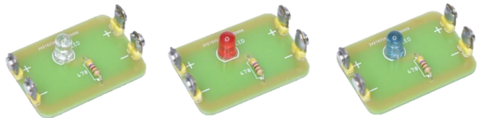
a) Módulo de luz com LED de alto brilho
