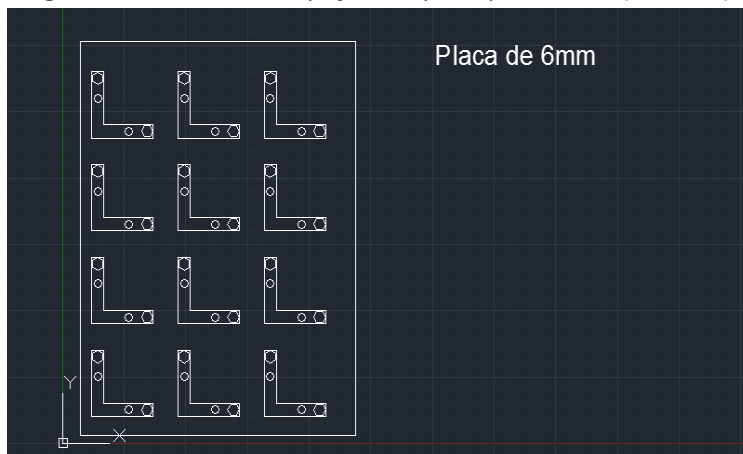
Figura 6 – Desenho 2D da peça de suporte para o laser (AutoCad).
