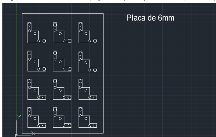
Figura 7 – Desenho 2D da peça de suporte para o laser (AutoCad).
