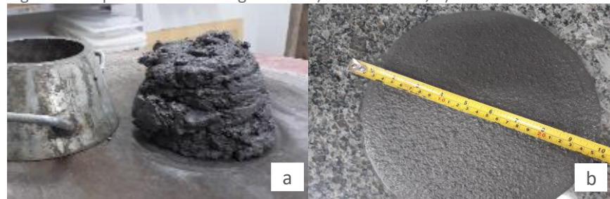
Figura 4 – Espalhamento da argamassa a) Areia natural, b) Areia normalizada
