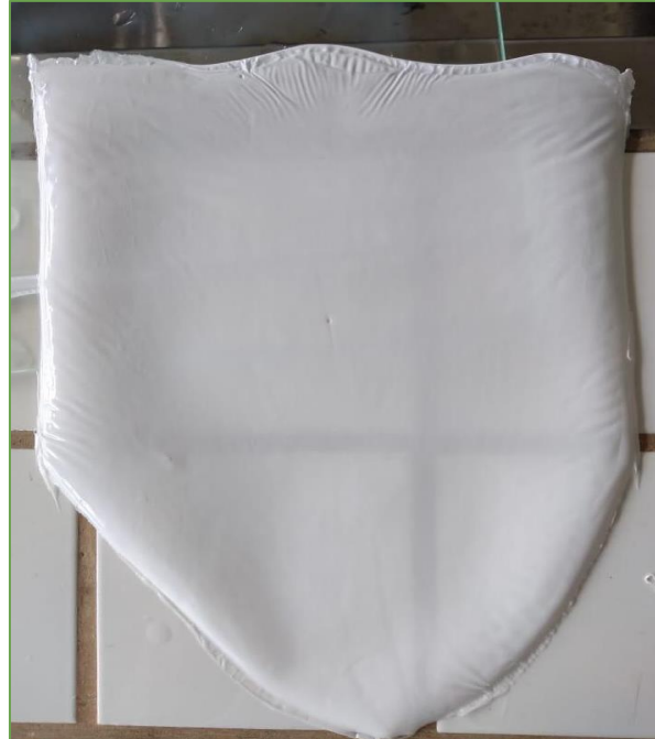
Figura 2 – Membrana logo após retirada de banho em água destilada
