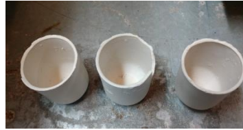
Figura 4 – Cadinhos queimados a temperatura de 1200°C.
