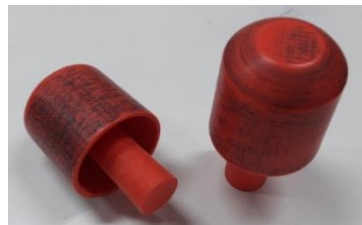
Figura 2 – Cadinhos impressos na impressora 3D.
