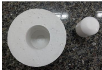
Figura 2 – molde de gesso e “macho” de nylon.
