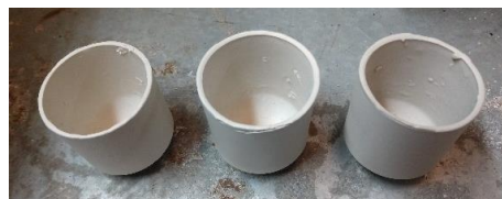
Figura 3 – Corpos de prova (São Simão) após queima a 1100°C.
