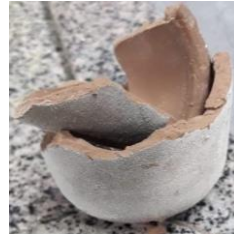
Figura 4 – Corpo de prova (SG) quebrado após retirada do molde.
