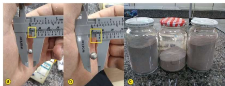
Figura 2 – Esferas de aço e compósito utilizados na moagem
