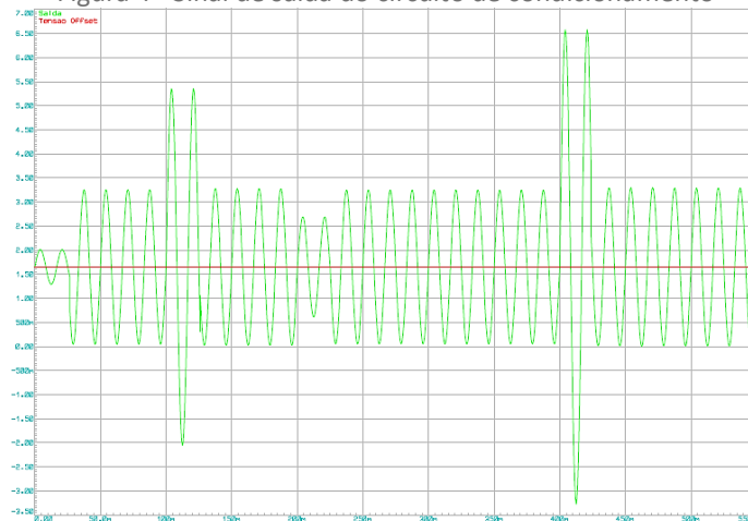
Figura 4 - Sinal de saída do circuito de condicionamento
