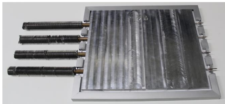
Figura 6 – Configuração final do sistema painel fotovoltaico - termossifões
