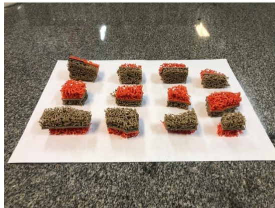
Figura 2 – Matrizes cúbicas de fibra vinílica entrelaçada utilizada como material suporte
