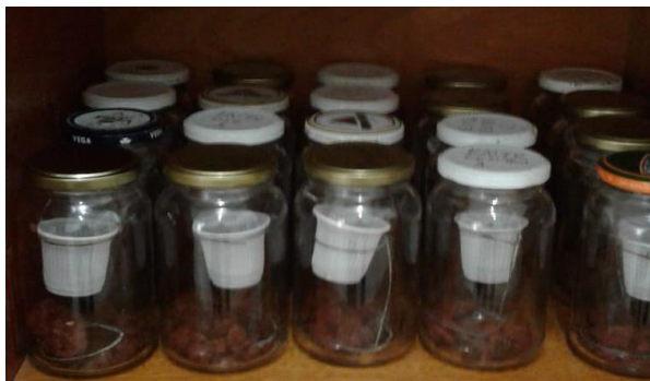
Figura 2: Frascos de respirometria com amostras de solo do local do estudo.
