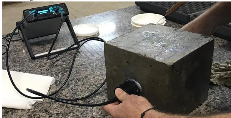
Figura 1 - Ensaio de ultrassom: transmissão direta da onda
