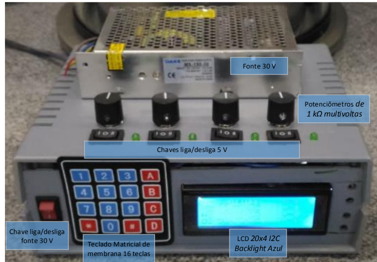
Figura 2 – Dispositivo eletrônico desenvolvido para controle de fluxímetros (externo)
