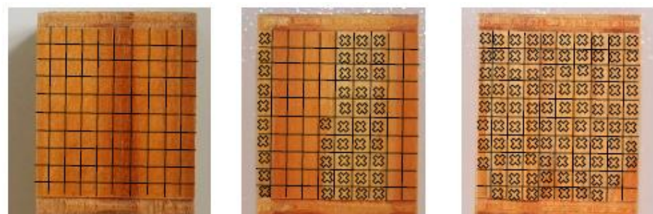
Figura 1 – Classificação da porcentagem de falha na madeira: (a) 0% (b) 45% (c) 95%
