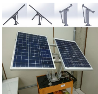
Figura 1 –Estrutura fixada em base móvel com as placas fotovoltaicas montadas.
