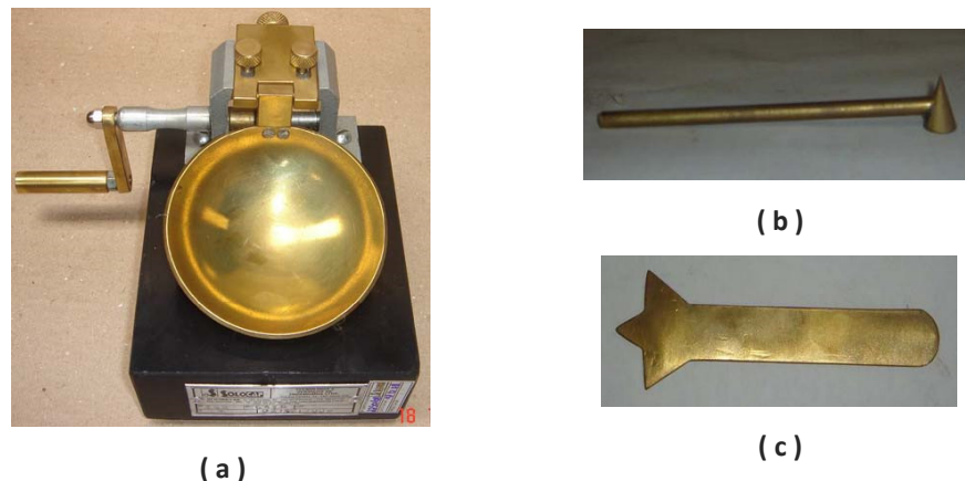
Figura 1 – Aparelho proposto por Casagrande: (a) concha fixada à base de borracha; (b) e (c) exemplos de cinzéis.
