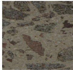
Figura 1 – Composições de concreto (cimento : areia : brita : água): (a) 1 : 1,49 : 2,88 : 0,48; (b) 1 : 1,49 : 2,70 : 0,48.
