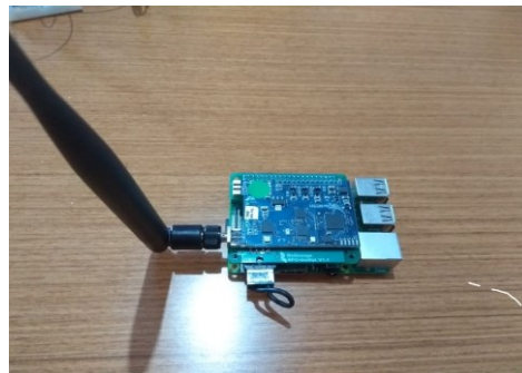
Figura 2 - Gateway LoRaWAN RD43HAT sobre um raspberry Pi.
