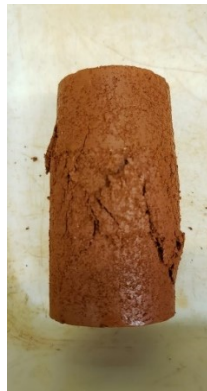
Figura 2 – Cp após rompimento no ensaio de compressão simples
