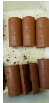
Figura 4 – Corpo de prova após ensaio de compressão diametral.
