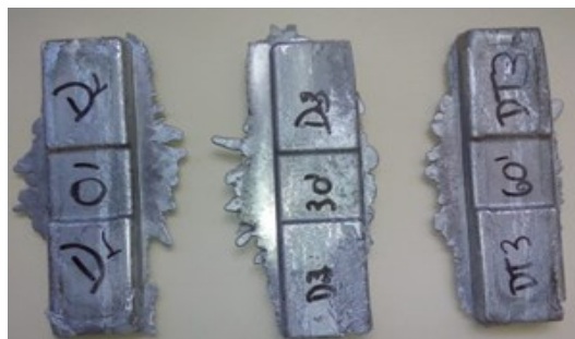
Figura 2 – Amostras tixoconformadas com 0s, 30s e 90s de retenção
