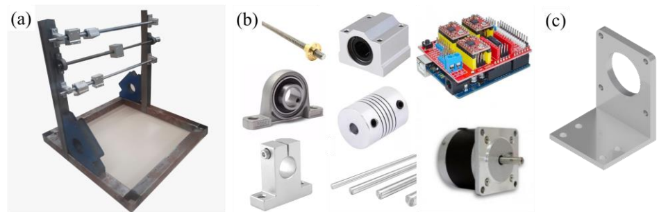
Figura 3 – (a) Estrutura CNC (b) suportes, eixos e eletrônicos (c) Suporte motor de passo.
