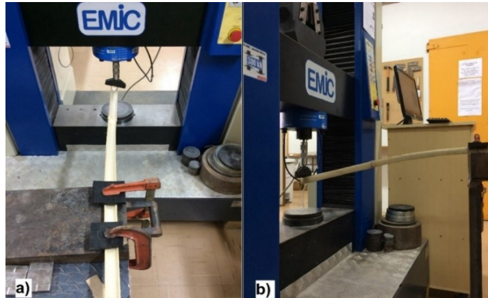
Figura 4 – Esquema para ensaio à flexão - a) vista superior b) vista lateral
