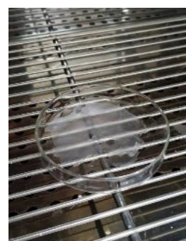
Figura 4 - Filme sintetizado na placa de Petri
