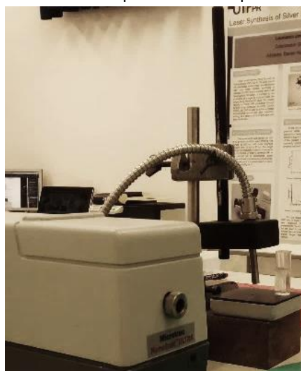
Figura 4 -Equipamento de Espalhamento Dinâmico de Luz (DLS), para medidas de tamanho e dispersão de nanopartículas.
