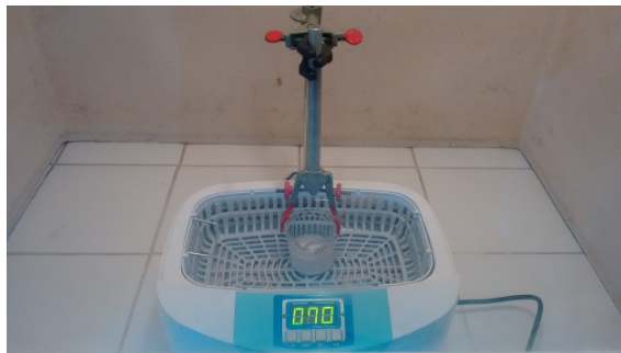
Figura 1 – Béquer com a mistura de isopropóxido de titânio e cloreto de bário. Dentro de uma cuba de ultrassom (marca: Cristófoli, frequência ultrassônica = 42 kHz, P = 160 W)
