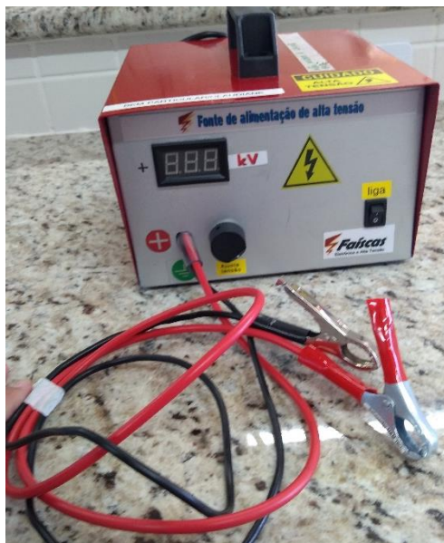
Figura 5 – Fonte de alta tensão
