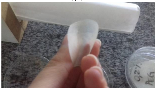
Figura 2: Fotografia de uma membrana de NCB utilizando PEG 600 na concentração de 0,1%.
