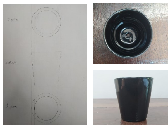
Figura 4 – Representação de um copo: vistas superior, lateral e inferior
