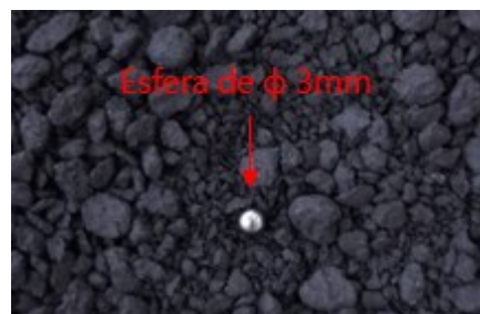
Figura 5 – Comparação do tamanho de partícula da baquelite não moída com uma esfera de 3mm de diâmetro
