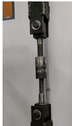
Figura 2 – Montagem do ensaio de adesão.
