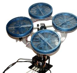
Figura 1 – Modelo físico do Quanser<sup>®</sup> 3-DOF Hover
